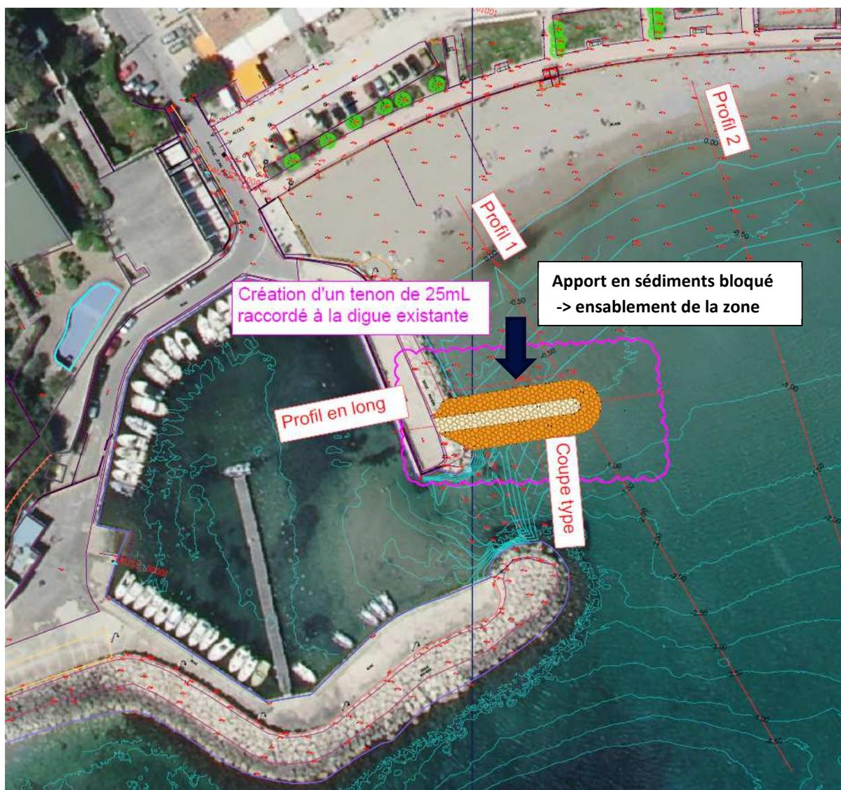
Figure 10 : Localisation du Tenon en enrochements - scénario retenu (Suez, 2020)
