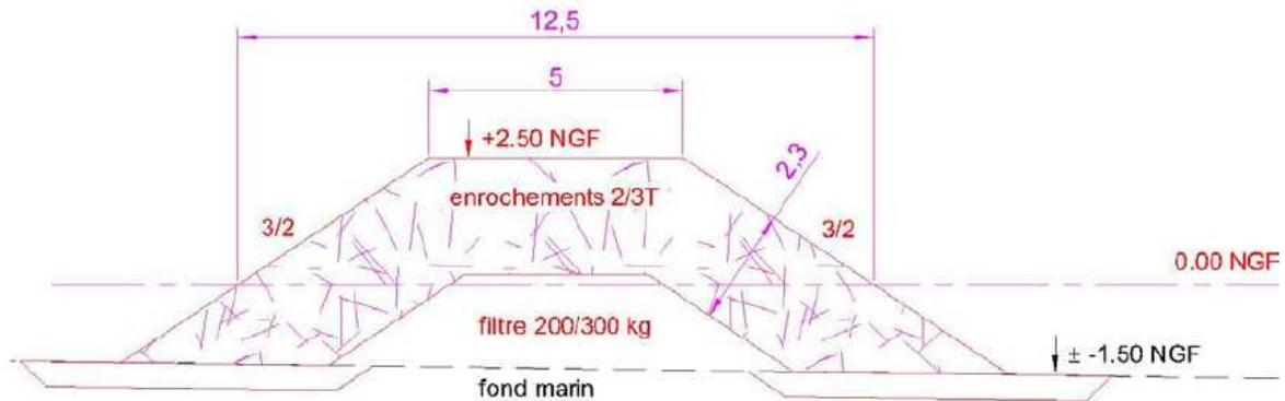
**Figure 9 : Coupe type de l'ouvrage de protection de la base nautique.**
